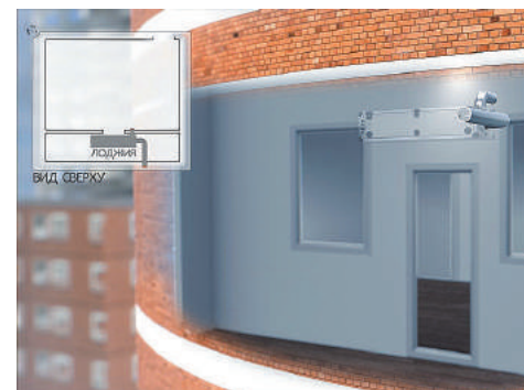
Монтаж на лоджии. Способ 3.
