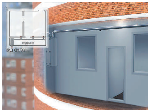
Монтаж на лоджии. Способ 1.
